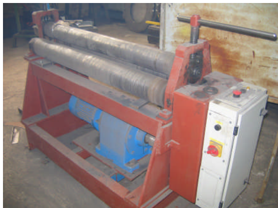
NAZIV Krožno krivilni stroj za plošče,
