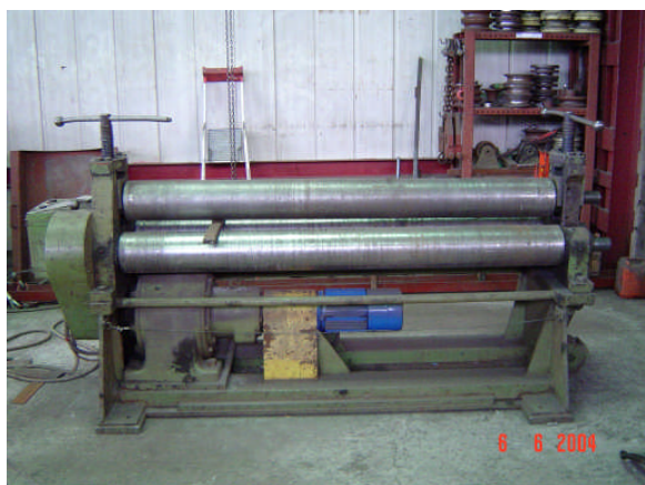
TITEL Rundbiegemaschine für Platten und Profile
