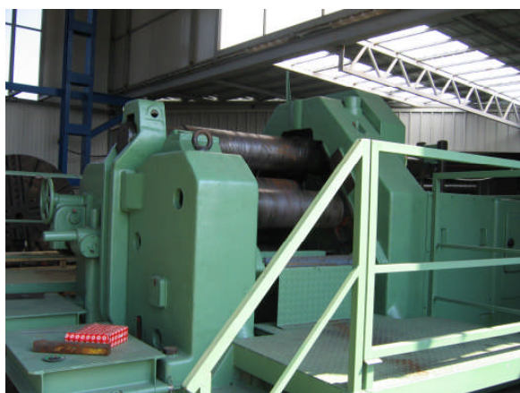
TITEL Rundbiegemaschine für Platten und Profile, Hersteller WEINGARTEN De.
