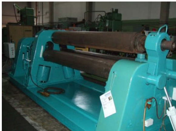
TITEL Rundbiegemaschine für Platten und Profile, Hersteller ROUND0 Belgien
